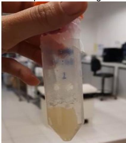
**Figura 2.** Oleogel estruturado pela mistura de *gelators* HPMC:CHI na proporção de 80:20.
