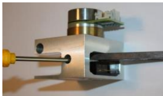
Figura 2 - Montagem do encoder de direção.
