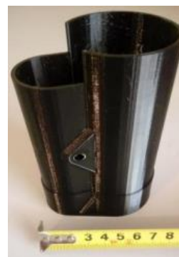
Figura 8 - Proteção dos motores elétricos.
