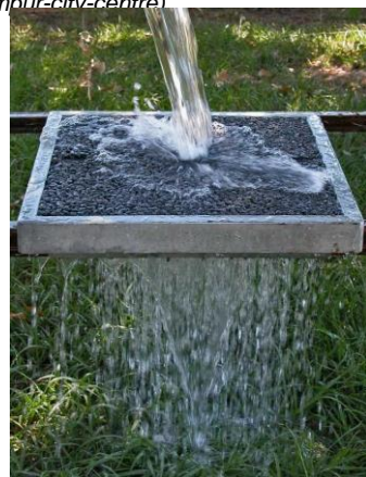
Fig. 8 – Piso permeável (fonte: https://www.updateordie.com/2015/04/11/concreto-permeavel-pode-reduzir-problemas-de-enchente/ )
