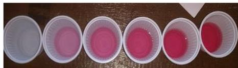
Figura 5: soluções padrão de corante alimentício. Da esquerda para a direita, as concentrações são 0%, 20%, 40%, 60%, 80% e 100% de  $C_o$ .
