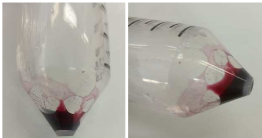
Fig. 2. Fotos do complexo polieletrólítico com nanopartículas de ouro obtido após titulação, centrifugação e descarte do sobrenadante.
