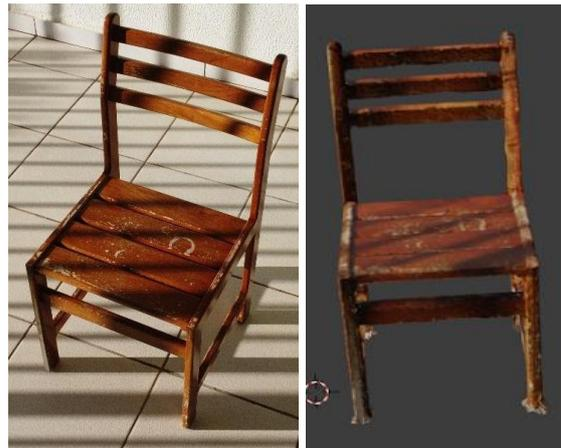
Figura 1: Comparação entre o objeto real e o 3D gerado por meio da fotogrametria. Fonte: Autoral
