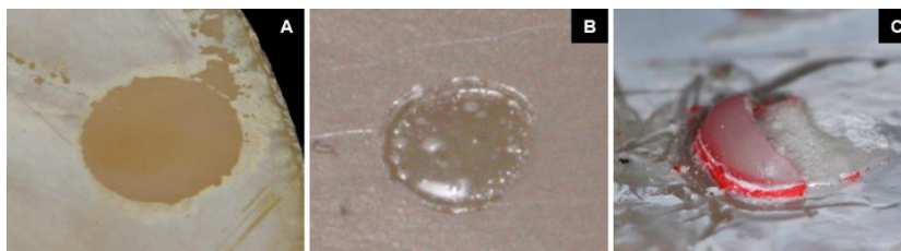
Figura 4: Imagem representativa do padrão de falha observado nos grupos experimentais após o ensaio de resistência de união - A Adesivo-PEEK; B Adesivo-Resina; C Resina.
