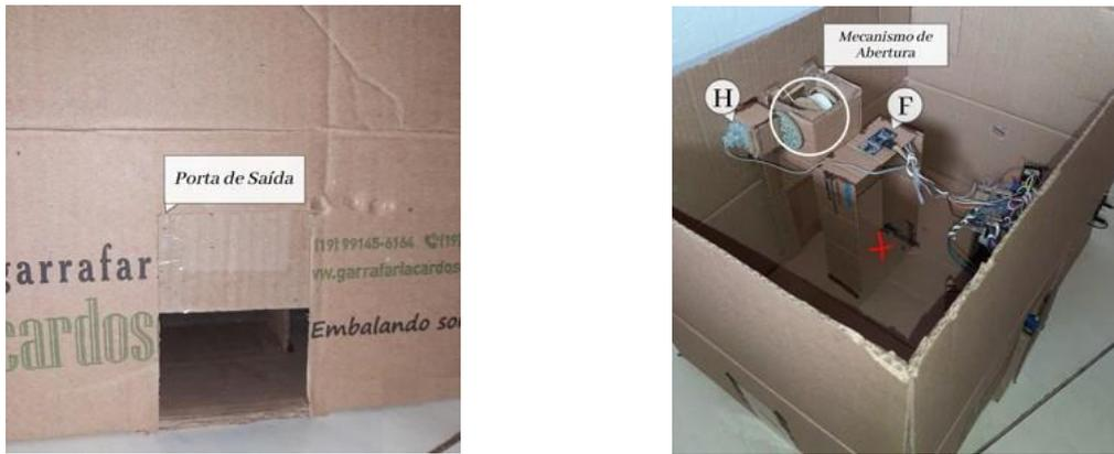
Figura 8 - Porta de saída e seus dispositivos (vista externa e interna respectivamente)
