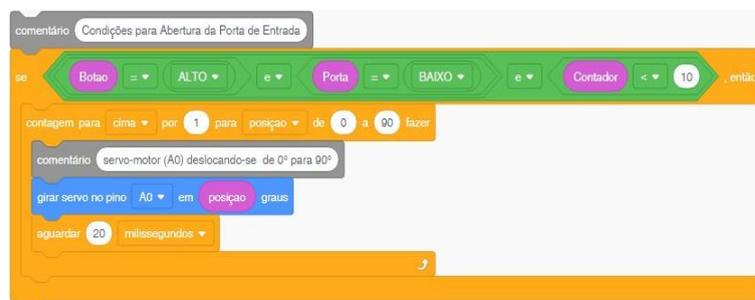
Figura 5 - Programação em blocos para o abertura da porta de entrada
