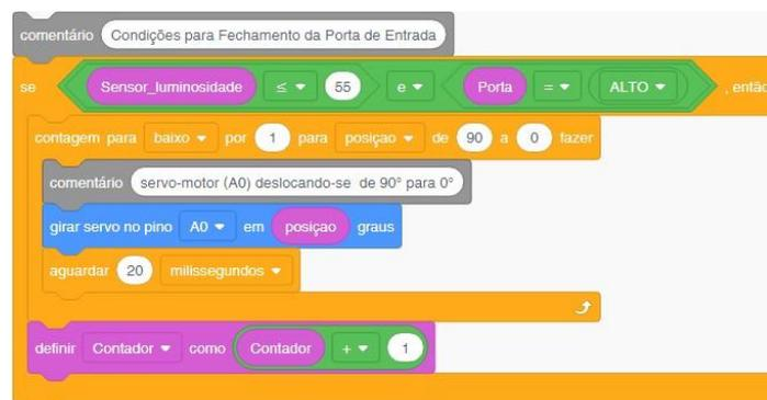
**Figura 7 - Programação em blocos para o fechamento da porta de entrada**
