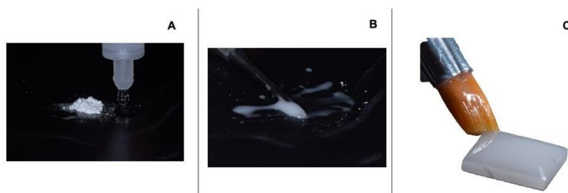
Figura 3: A: Proporção pó + líquido do glaze. B: processo de de manipulação do glaze e C: aplicação com auxílio de pincel sob a superfície do corpo de prova.
