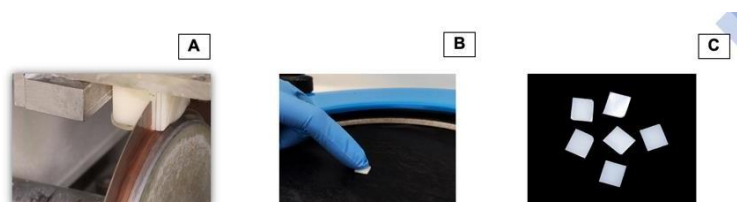
Figura 1: A: imagem representativa da obtenção das fatias de cerâmicas em cortadeira metalográfica. B: processo de polimento dos corpos de prova em politriz giratória e C: aspecto final dos corpos de prova.
