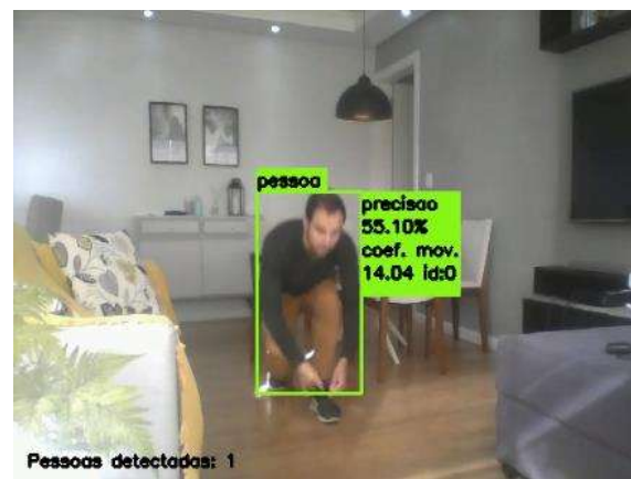
Figura 6- Teste da velocidade corpora e o modelo pré-treinado de dados MobileNet-SSD.
