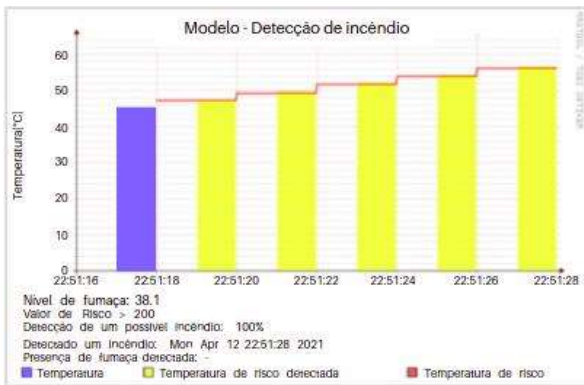
Figura 4- Teste de funcionamento da detecção de incêndio com os dados do sensor DHT-11.
