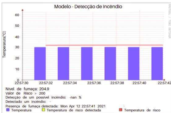
Figura 5- Teste de funcionamento da detecção de incêndio com os dados do sensor MQ-2.
