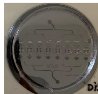
Figura 3. Fotolito industrial usado como máscara para litografia.
