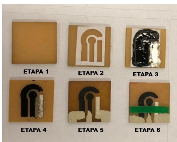
Figura 1. Principais etapas do processo de fabricação dos eletrodos impressos portáteis utilizando tintas condutivas de carbono e Ag/AgCl em substrato de fenolite.
