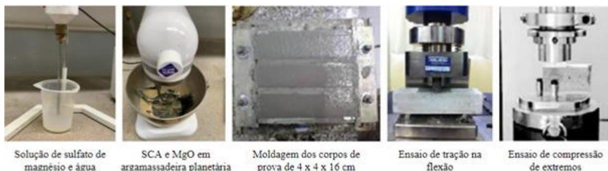
No decorrer do processo de cura, realizou-se uma análise dimensional onde mediu-se com o auxílio de um paquímetro eletrônico o comprimento longitudinal de cada corpo de prova afim de analisar variações de expansibilidade de um traço para o outro. Além disso, deu-se uma análise das propriedades físicas de acordo com a NBR 9778 - Argamassa e concreto endurecidos – Determinação da absorção de água por imersão índice de vazios e massa específica.
