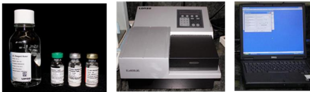
Figura 1. Processamento de endotoxinas pelo ensaio LAL. A - Kit de endotoxinas composto por água apirogênica, Tampão de reconstituição Pyrogen-5000 LAL, Reagente Pyrogen-5000 LAL e Endotoxina E. coli 055:B5; B - Leitor Biotek (ELX 808, Winooski, VT, EUA); C - Software WinQCL (Lonza, Walkersville, MD, EUA)
