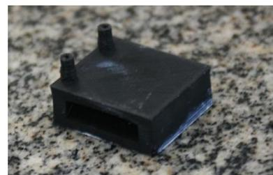
Figura 6 – Microdispositivo microfluídico de PLA eletricamente condutor
