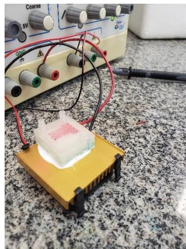
Figura 4 – Detalhe do microdispositivo impresso em impressora 3D baseada em FDM colado no cooler – fonte: arquivo pessoal
