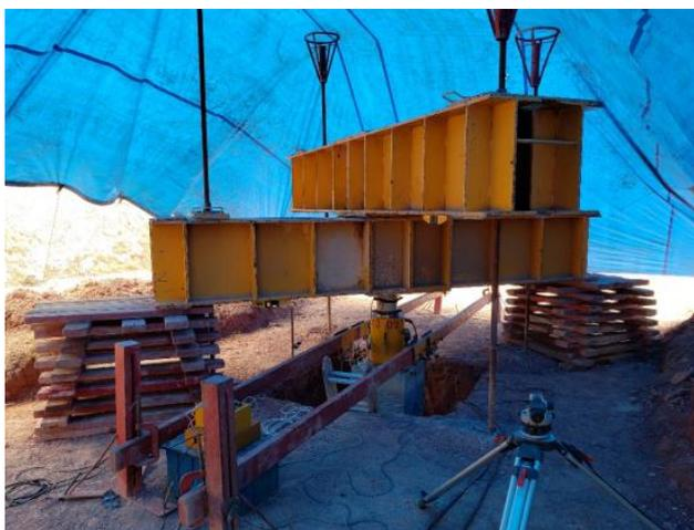
**Figura 2: Configuração de PCE. Fonte: Geoprova Engenharia Ensaios e Monitoramento Ltda (2020).**
