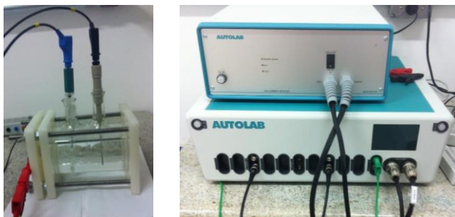
Figura 2: (a) Célula eletroquímica e (b) Equipamento Metrohm Autolab modelo PGStat 302N
