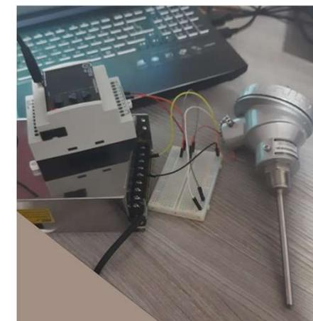
**Fig. 7 - Pt100 ligado na fonte de 24 Volts e conectado às entradas do Norvi - Imagem dos autores**
