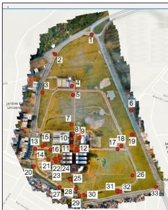
Figura 1: planejamento dos pontos de controle no campus 2 da UNICAMP em Limeira
