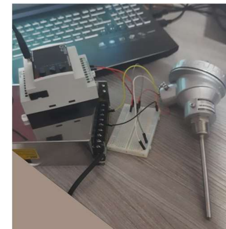
Fig. 7 - Pt100 ligado na fonte de 24 Volts e conectado às entradas do Norvi - Imagem dos autores
