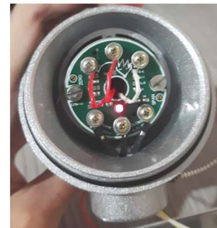
Fig. 8 - Pt100 ligado visto por dentro - Imagem dos autores
