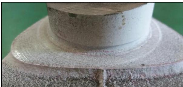
Figura 6 – Local de início da trinca experimental devido ao esforço de flexão – fonte: MORAES, 2017
