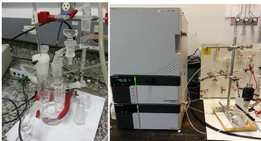
Figuras 2 e 3: À esquerda, um exemplo de célula eletroquímica utilizada para caracterizar catalisadores. À direita, o HPLC acoplado a uma célula eletroquímica.
