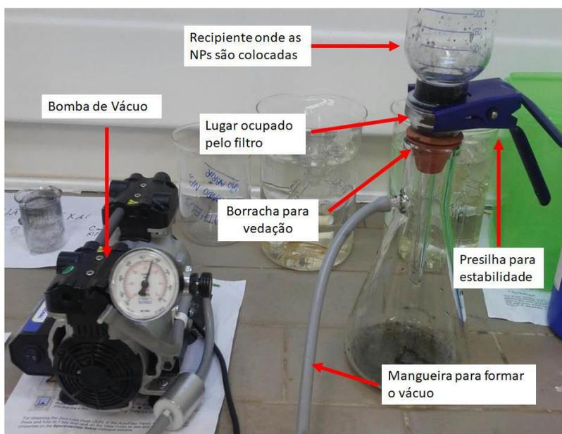
Figura 1: sistema de filtração à vácuo para secagem das NPs.
