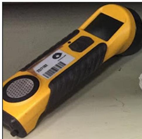
Figura 2: Suscetibilímetro portátil modelo KT-10 da Terraplus.
