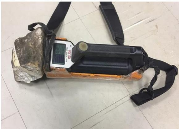
Figura 3: Gamaespectrômetro portátil modelo RS-230 da Radial Solutions.
