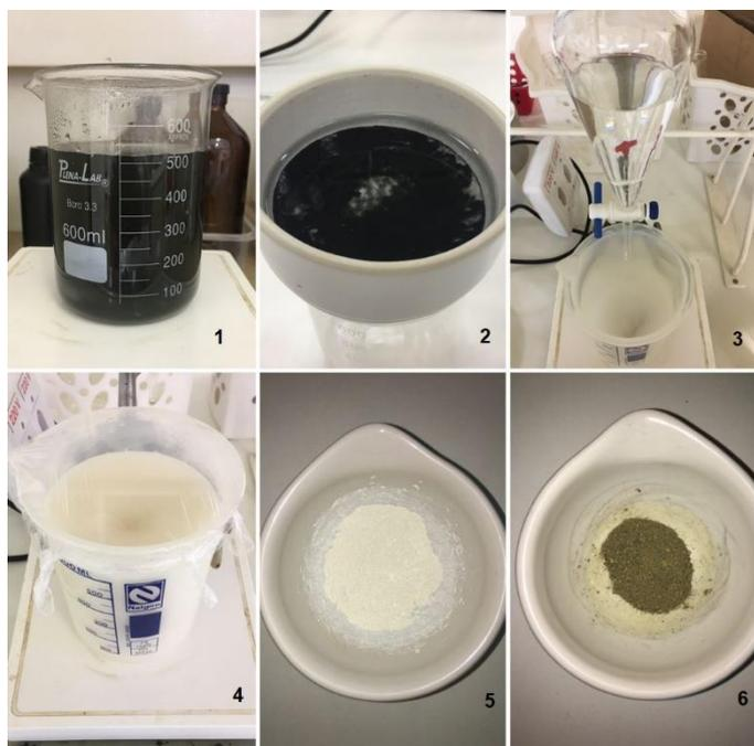
Figura 3- Tratamento da lama e síntese da hidrocalumita. Em sequência: tratamento com HCl (1), filtração dos óxidos (2), gotejamento lento (3), agitação por 24h (4), hidrocalumita da lama Grits (5), hidrocalumita da lama Dregs (6)
