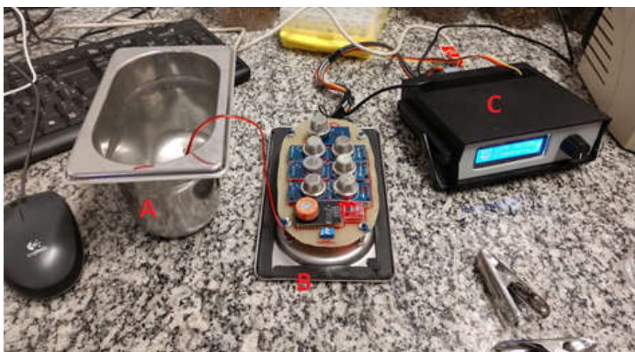
Figura 1: Protótipo do nariz eletrônico A) câmara da amostra , B) Tampa hermética com os sensores, C) Sistema de controle e aquisição de dados.
