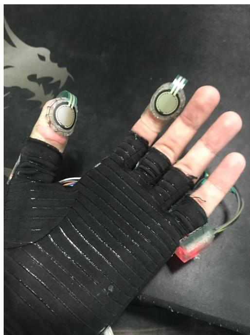
Figura 4: Sensores de pressão posicionados no dedão e dedo indicador
