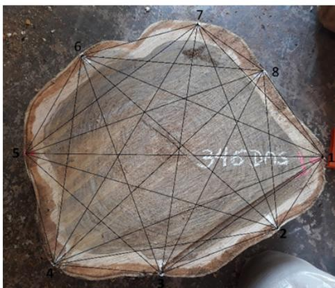
Figura 1 - Malha de difração de 8 pontos.
