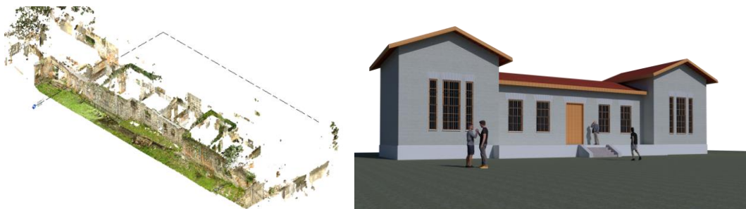
Figura 2. Nuvem de pontos da Casa da Economia (esq.) e modelo final (dir.) – fonte: os autores.
