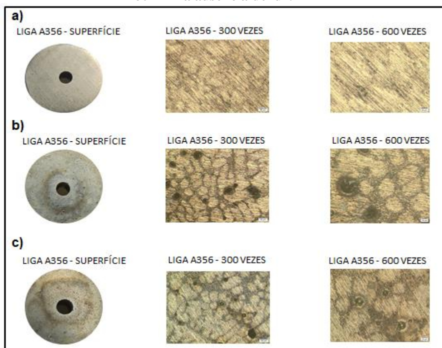
Figura 3. Superfície e microscopia da liga A356 (a) 0h; (b) 6072h na presença de luz (c) 6072h na ausência de luz.
