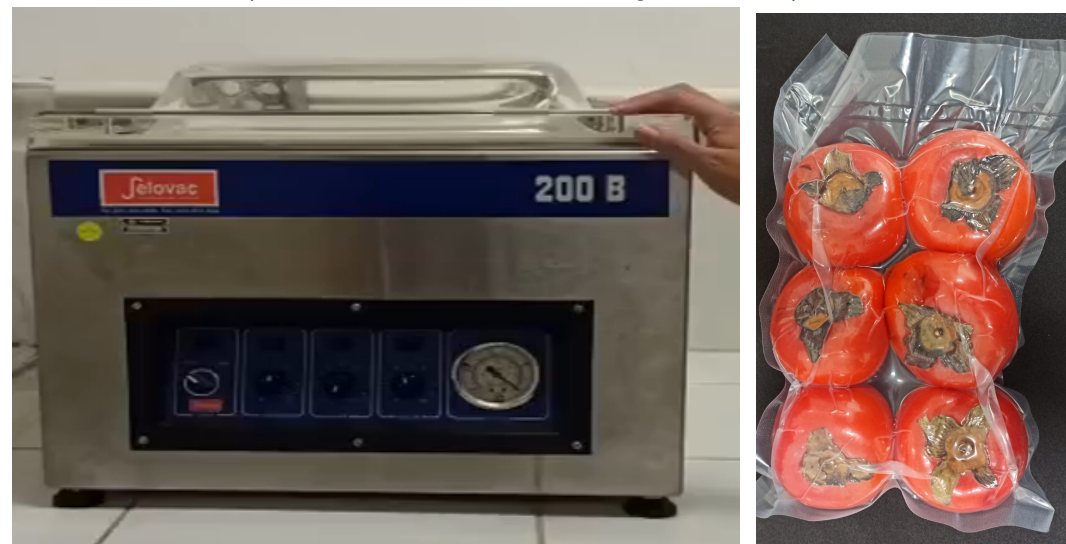
Figura 3: Seladora utilizada para embalamento à vácuo (esquerda) e caquis embalados à vácuo para teste de destanização utilizando embalagens plásticas (direita) (Créditos: Yasmim Cristina Rodrigues da Silva).
