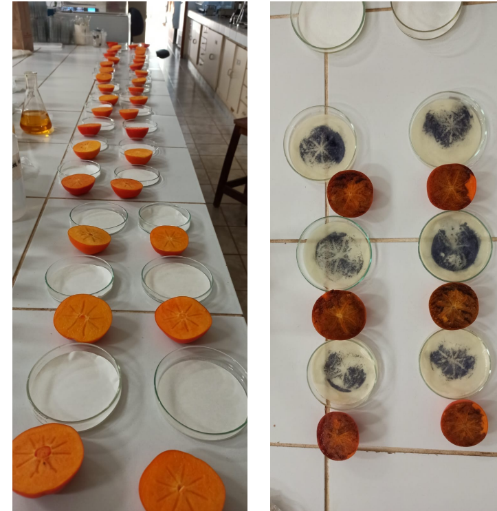
Figura 6. Realização de testes para determinação do índice de adstringência em caquis utilizando papel filtro papel-filtro, previamente tratado com solução de cloreto férrico. À esquerda, frutas antes do teste e à direita, após o teste (Créditos: Yasmim Cristina Rodrigues da Silva).
