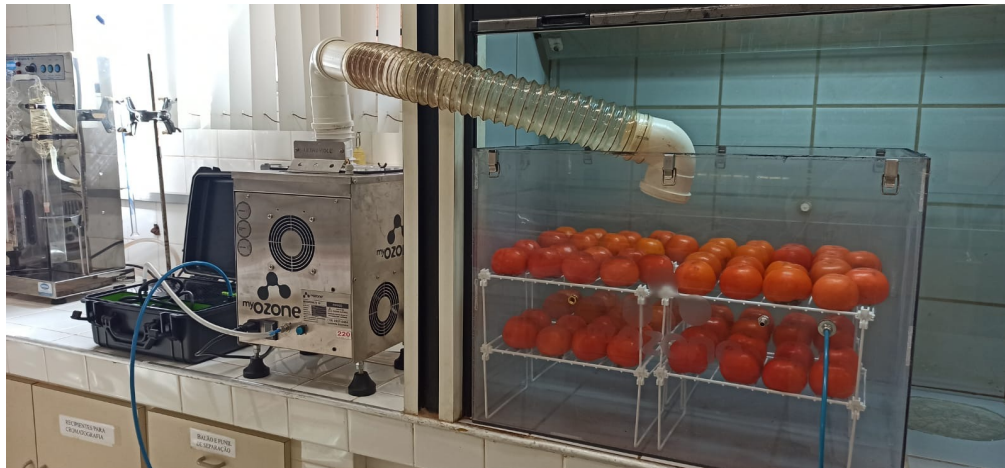
Figura 4: Aplicação do ozônio gasoso para diminuição da carga microbológica em caquis (Créditos: Yasmim Cristina Rodrigues da Silva).
