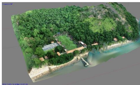
Figura 07 – Modelo 3D elaborado a partir da construção de nuvem esparsa, densa e classificação das imagens
