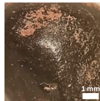
Figura 4: superfície polida. Quando observados em lupa, os fragmentos não apresentam tais feições . Pelo contrário, têm uma superfície lisa ou ligeiramente irregular .
