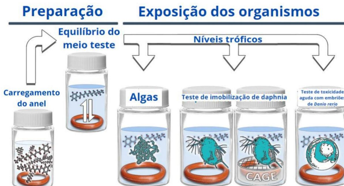
Figura 1: Representação das etapas da técnica de dosagem passiva. Adaptado de Stibany et al. (2020).
