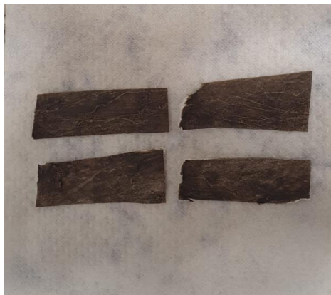
Figura 6: PCL incorporado ao óxido de grafeno, pelo método drop casting .
