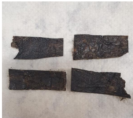
Figura 7: PCL incorporado ao óxido de grafeno, pelo método dip coating .
