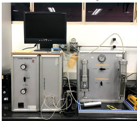
Figura 1: Porosímetro e Permeômetro utilizado nas medições. Fonte: Acesso Pessoal
