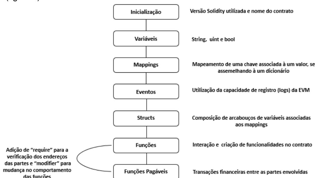
figura 3. Estrutura do Smart Contract programado. Fonte: Própria.
