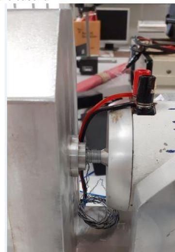
Figura 5 – Detalhe do contato do pistão com o suporte do tubo. Este atrito pode ter gerado distorções na medida da pressão sonora
