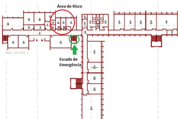
Figura 4 – Rota de fuga “natural” do edifício da Diretoria da FECFAU/Unicamp. Fonte: Autoral
