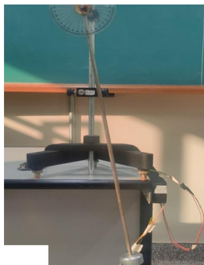
Figura 3b dispositivo posicionado a 10° da normal à aceleração da gravidade
