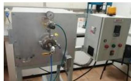
Figura 5 - Forno Elétrico com atmosfera controlada
