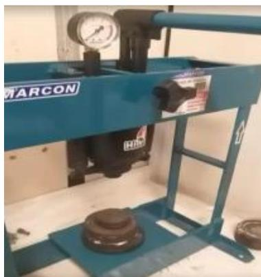
Figura 4 - Prensa Hidráulica Manual
