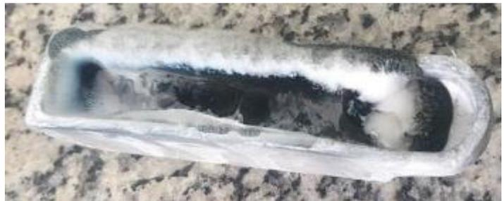
**Figura 6** - Resultados das amostras ternárias com 10% de Cobalto após sinterização na temperatura de 1300 °C
