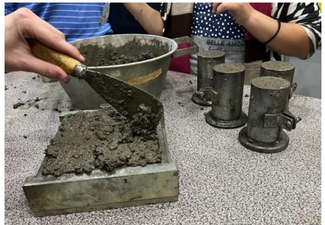
Figura 1 – Moldagem dos corpos de prova.
