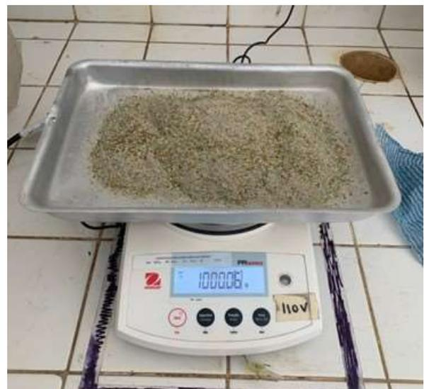
*Figura 2 - Categoria vidros aterrados após trituração (D < 3mm)*
