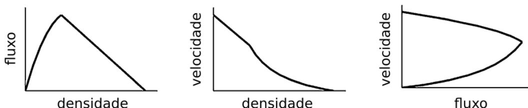
Figura 1: Relações fundamentais de fluxo de tráfego veicular. Fonte: adaptado de [6].
