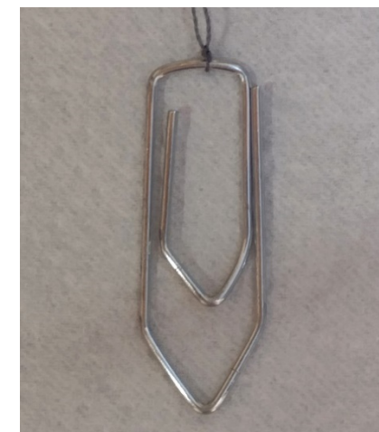
Fig. 2: Amostra do clip metálico durante o tempo 0 h (antes da imersão)
