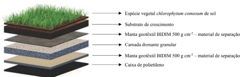
Imagem 2 – Camadas dos protótipos de TV; Adaptado de Ecotecnologias (2021)
