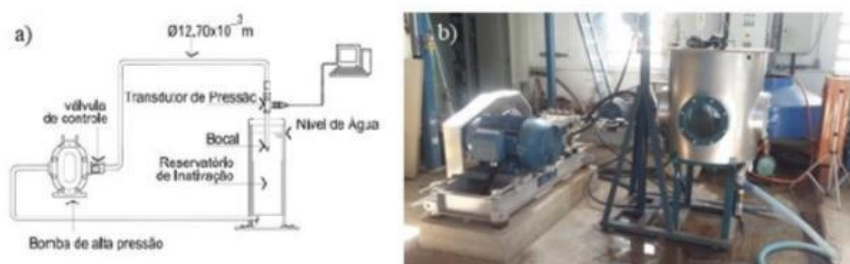
Figura 1. a) Esquema do equipamento tipo jato cavitante (Fonte: DALFRÉ FILHO et al., 2015); b) Foto do equipamento tipo jato cavitante (Fonte: os autores).
