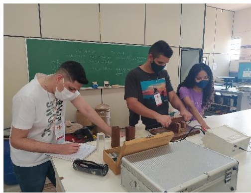
Figura 2. Ensaio de ultrassom realizado pelos alunos.
