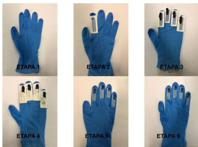
**FIGURA 1.** Imagens demonstrando as principais etapas do processo de fabricação dos eletrodos impressos na luva utilizando tintas condutivas flexíveis de carbono e Ag/AgCl em substrato de luvas nitrílicas.
