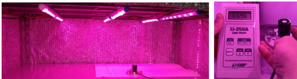
Figura 1: Prateleira de cultivo, com destaque para distribuição da luz pelas lâmpadas LED, e radiômetro utilizado para medição.
