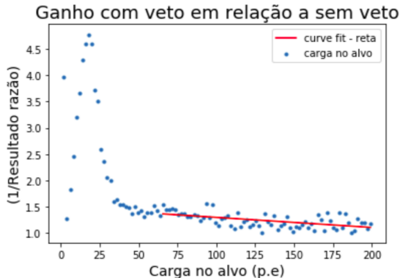
Figura 6: Ajuste linear feito na região de interesse para estimar o ganho do detector nessa região
